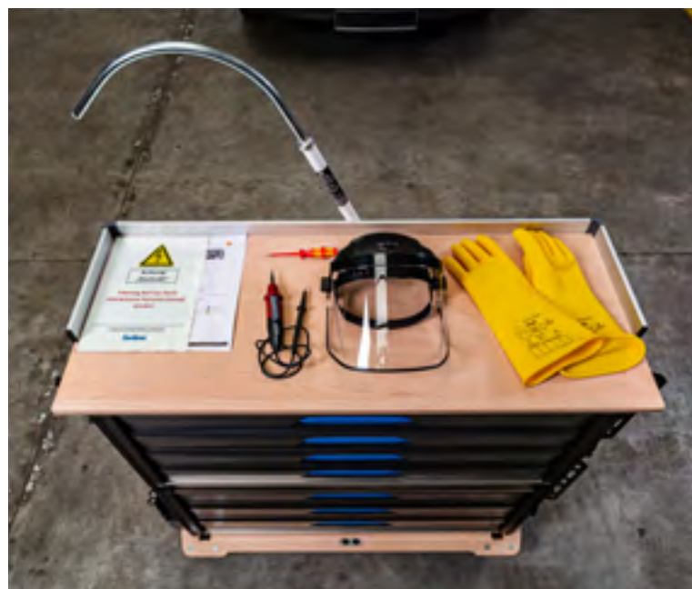
Mobil högspännings arbetsplats
